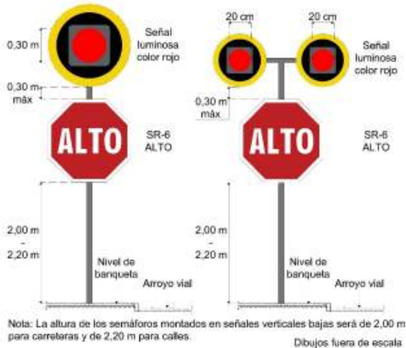
Figura VI.5-23 Semáforo de destello de alto
