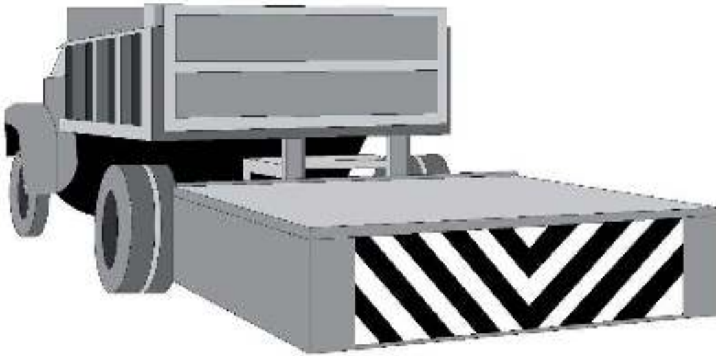
Figura V.8-3 Ejemplo de amortiguador de impacto móvil (OD-14/M)
