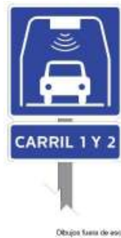
Figura VIII.2-6 Ejemplo de SIS-70 Pago de cuota con telepeaje con tablero adicional indicando carriles
