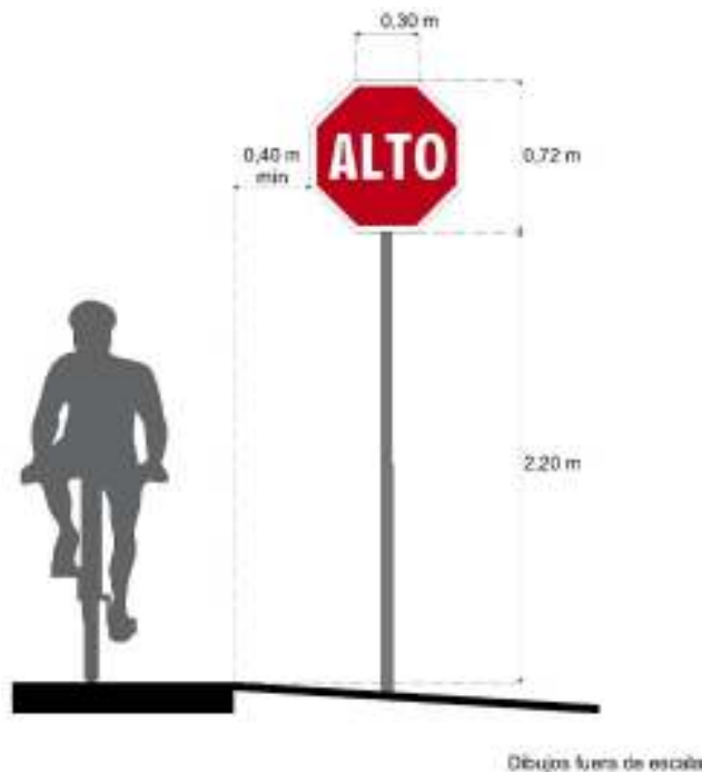
Figura VII.2- 22 Ubicación señales verticales para vías ciclistas
