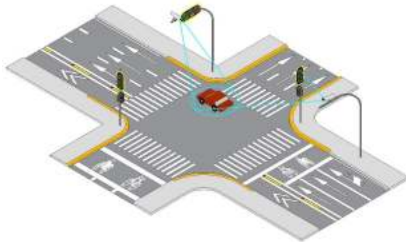
Figura VI.8-17 Ubicación de cámaras de detección para señal de pare en el semáforo
