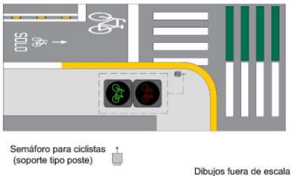
Figura VI.5-4. Semáforos en vías ciclistas
