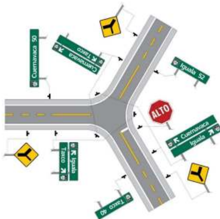
Figura VIII.2-39 Ejemplo de señales informativas de destino en intersección Tipo Y de carretera principal con carretera secundaria
