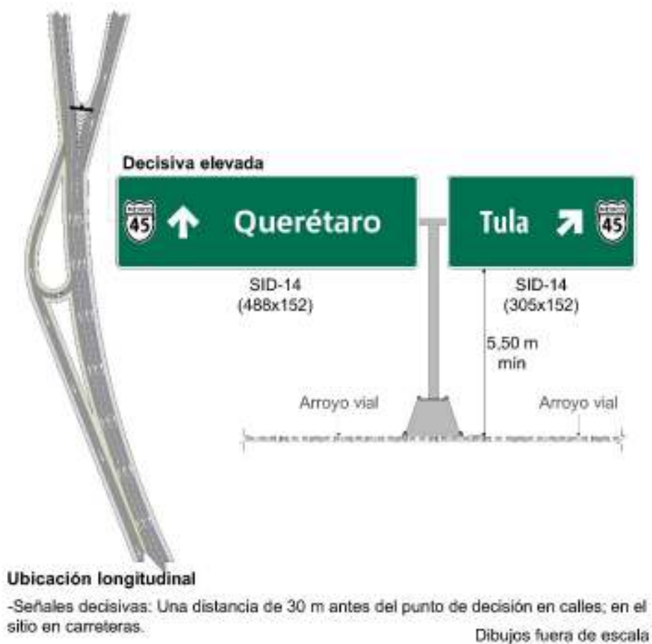
Figura III.4- 33 SID-14 Doble bandera (Acceso a población)
