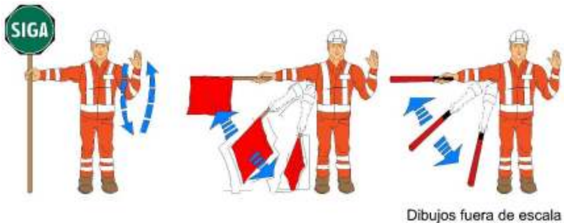
Figura V.6-15 Para alertar y disminuir la velocidad del tránsito
