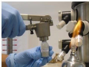
Figura 6. Sellado y etiquetado de muestras liofilizadas.
