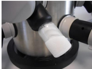
Figura 5. Secado del material a través de liofilización.
