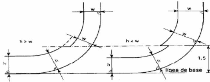
**Figura 1 - Definición de los límites de los tanques de carga a efectos del párrafo 3 de la presente regla**
