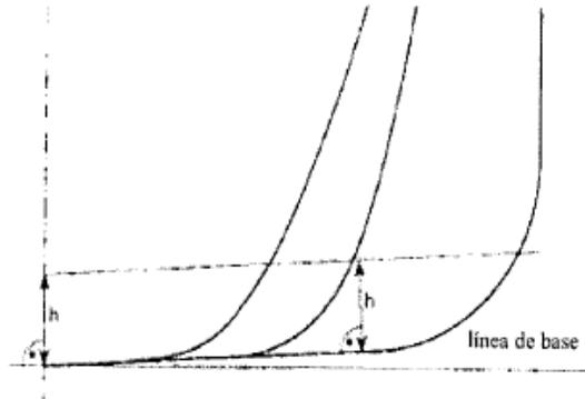
**Figura 1-Definición de los límites de los tanques de combustible líquido a efectos del párrafo 6**
