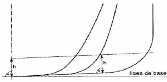
**Figura 3 - Definición de los límites de los tanques de carga a efectos del párrafo 6 de la presente regla**
