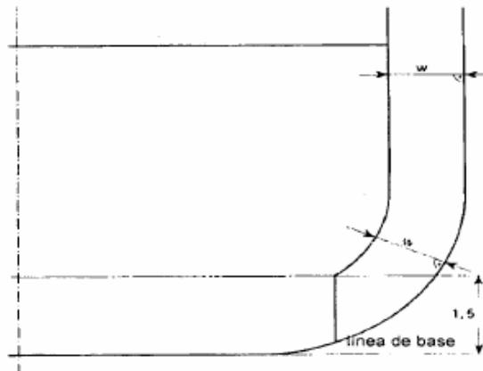
**Figura 2 - Definición de los límites de los tanques de carga a efectos del párrafo 4 de la presente regla**
