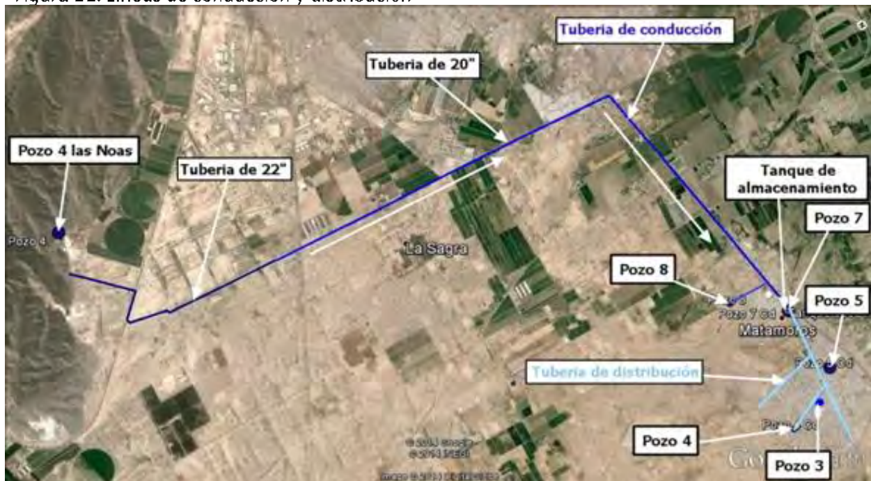
Figura 11. Líneas de conducción y distribución
