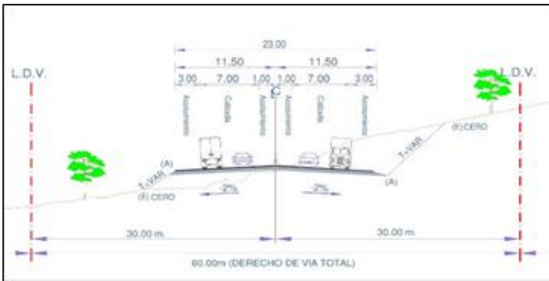
Figura 1. Características Geométricas de una carretera tipo A4.
