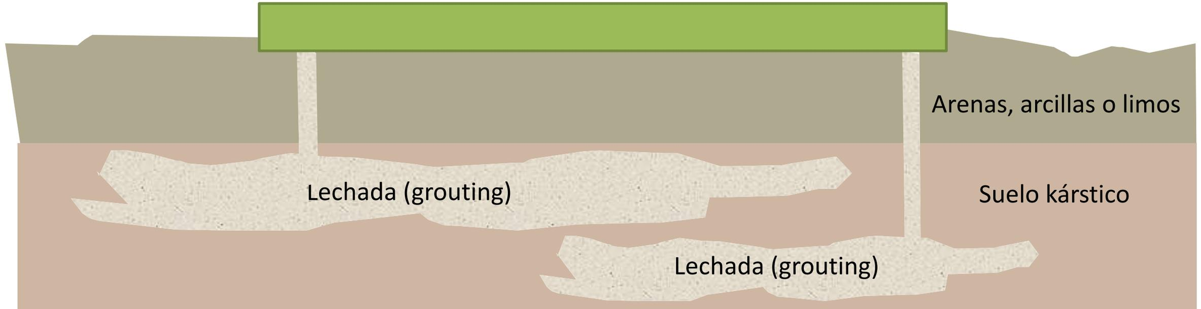
**Ventajas:** Incrementa la capacidad de carga del suelo debido a que la lechada tiende a expandirse y compactar el suelo circundante.
