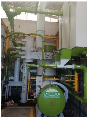
Fotografía 24. Sistema para destrucción térmica de residuos sólidos como combustible, junio de 2020. Proyecto Mecanismo de Fondo revolvente para el Financiamiento.
