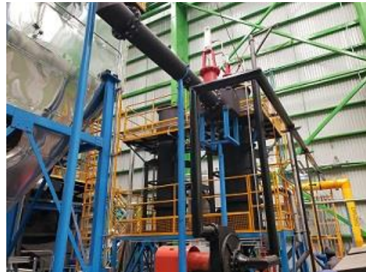
Fotografía 52. Planta operativa, diciembre de 2022. Proyecto Valorización de fracción orgánica de residuos sólidos urbanos (FORSU) mediante carbonización hidrotermal. UNAM.
