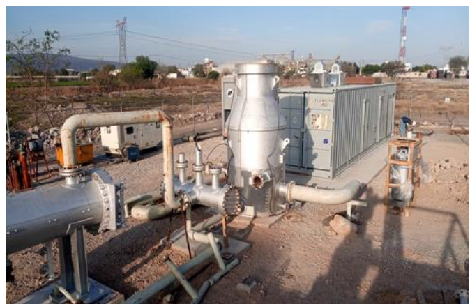
Fotografía 25. Instalación y pruebas con vapor geotérmico en condiciones reales de campo de la unidad BPU 500 kW Proyecto Mecanismo de Fondo revolvente para el Financiamiento.
