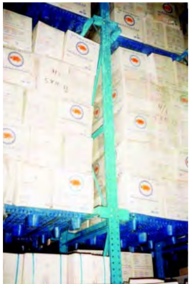
Figura 6.13 El acomodo en la cámara de conservación en congelación debe permitir que el producto mantenga su temperatura.
