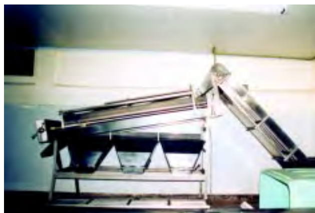
Figura 6.8 Máquina para separar el camarón por talla.
