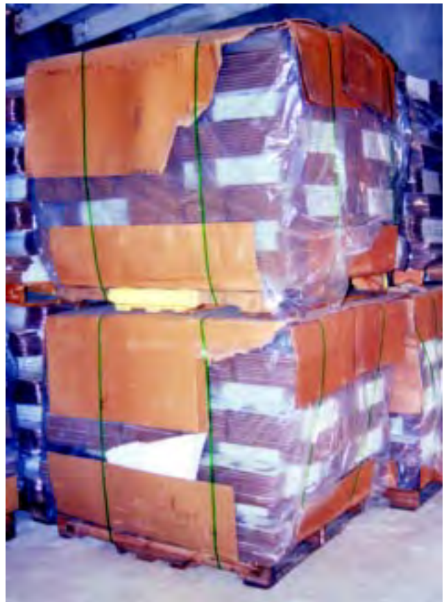
Figura 5.4 Material de empaque protegido con plástico y cartón para evitar su contaminación.
