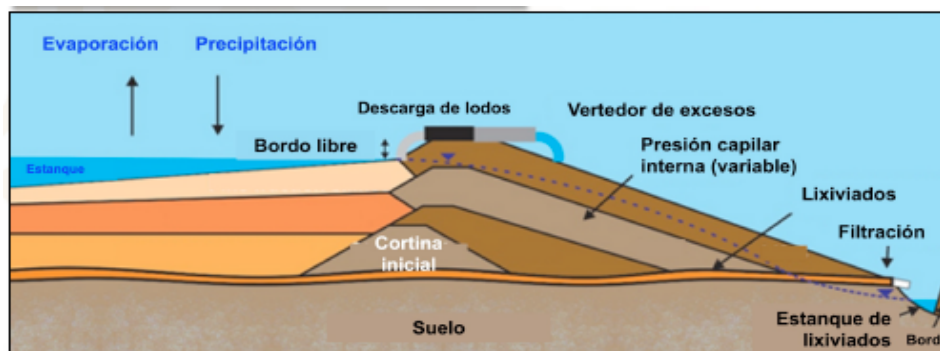
Figura 7. Vista en perfil longitudinal de una presa de jales y sus principales elementos que la componen.
