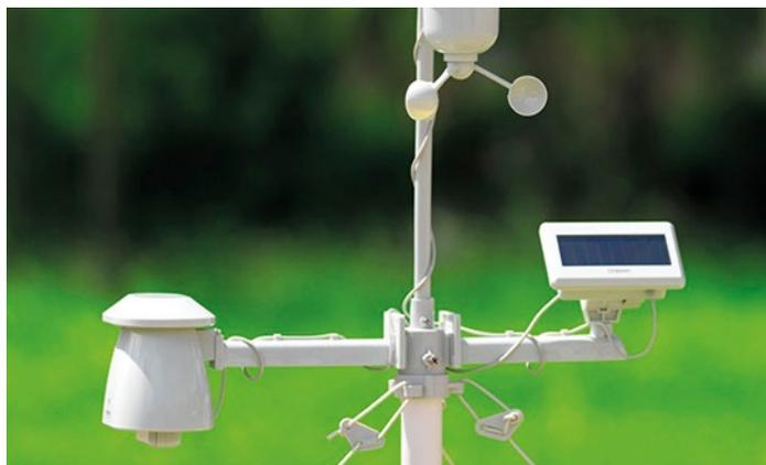
Una estación climatológica se define como un conjunto de instrumentos colocados a la intemperie que permiten medir las variables del clima, como la precipitación, temperatura, evaporación, viento, tiempo y la visibilidad, y están colocados en sitios estratégicos representativos de ambientes diversos.
