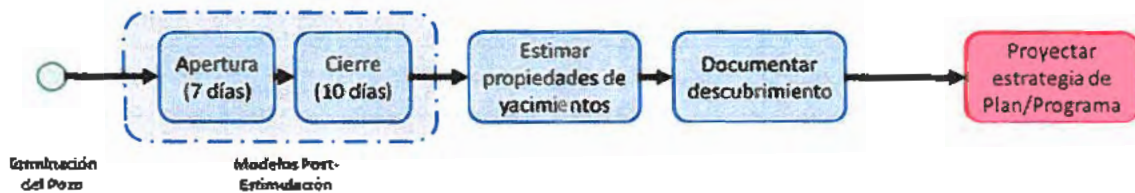
Figura 10. Proceso de la Prueba de Producción. (Fuente: CNH con información del Contratista).
