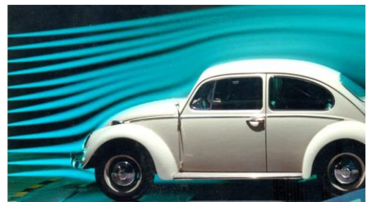
Imagen 1. Líneas de flujo exterior. Fuente: Actualidad motor
