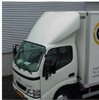
Imagen 2. Deflector de aire en el techo de la cabina. Fuente: Cargoback
