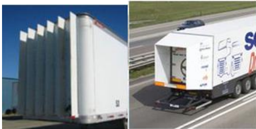
Imagen 3. Estabilizador de vórtices y cola de barco. Fuente: cargoback
