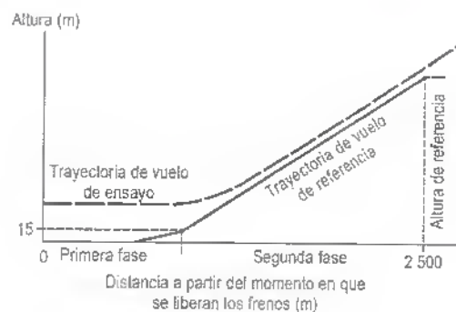
Figura A6-1. Perfiles de ensayo y de referencia típicos.
