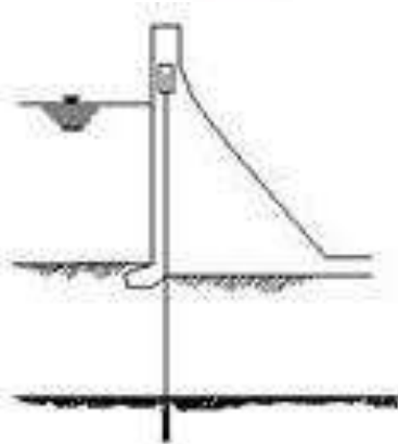
b) Estabilización de una presa de concreto
