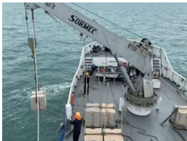
Figura 3. Buques balizadores durante la colocación de los bloques
