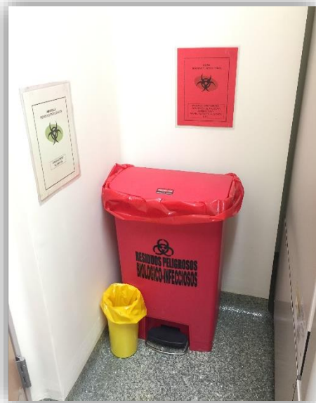
Fig. AI.6. Disposición de residuos biológico-infecciosos no anatómicos en bolsa roja, patológicos en bolsa amarilla (a) y residuos químicos (b).
