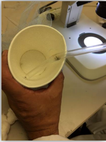
Fig. A1.3. Uso de tubo capturador para separación de muestras de mosquitos en insectario. El uso de este dispositivo impide el contacto directo entre los ejemplares y el analista.
