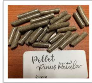
Uso del aserrín con la tecnología propuesta. Pellet de Pinus patula con buenos parámetros de calidad.
