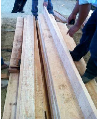
Tecnología tradicional. Tablas aserradas con variación de corte en grueso, mayor o igual a 15%.
