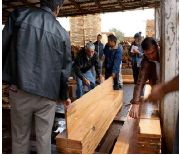
Tecnología generada. Tablas aserradas con variación de corte en grueso, inferior a 4%.
