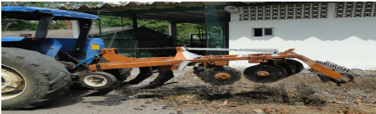
PREPARACIÓN SIMULTÁNEA EN UN SOLO PASO (LABRANZA PRIMARIA CON ARADO DE CINCELES+LABRANZA SECUNDARIA CON RASTRA Y DESTERRONADOR)
