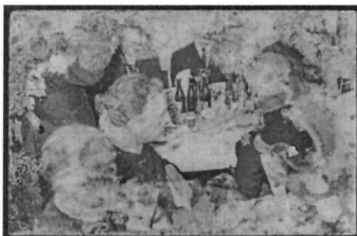
Ilustración 14. Manchas verdes, pardas y negras por crecimiento y pérdida de la imagen por hidrólisis de la gelatina derivado del metabolismo de hongos en una fotografía de plata gelatina. Foto: textures.com.
