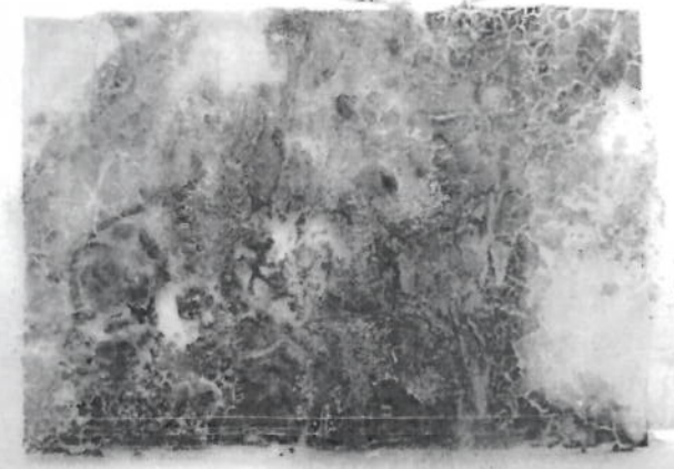
Negativos de nitrato de celulosa adheridos entre sí de nivel 6. Luz directa. Fotografía: Susana Segundo, AGN.
