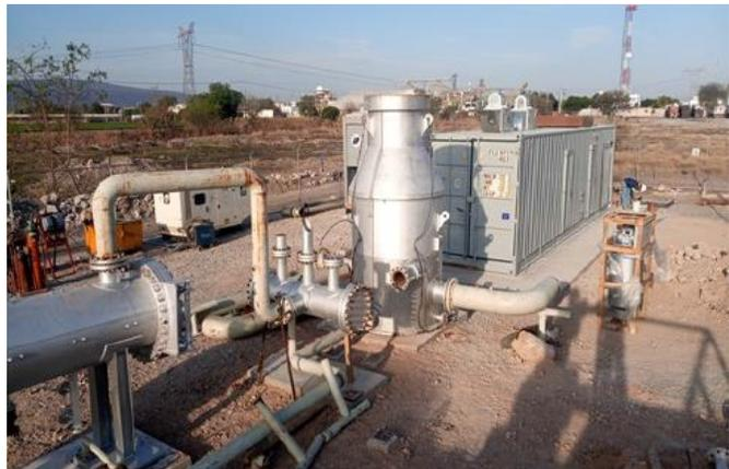
**Fotografía 23.** Instalación y pruebas con vapor geotérmico en condiciones reales de campo de la unidad BPU 500 kW Proyecto Mecanismo de Fondo revolvente para el Financiamiento.
