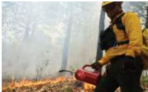
Imagen 36. Uso de la antorcha de goteo para la ejecución de quemas prescritas.
