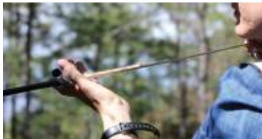
Imagen 12. Extracción de viruta de pino para determinar la edad y el tiempo de paso durante el muestreo de árboles en el Inventario Nacional Forestal en un área forestal de Nayarit.
