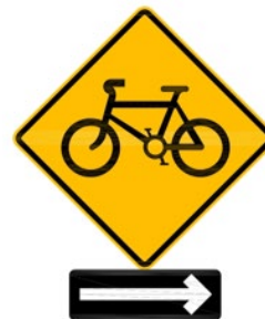
Señal preventiva: Cruce próximo de ciclovía
