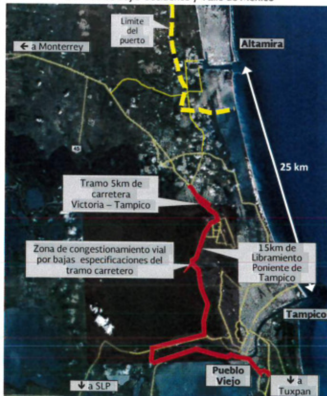
Flujo vehicular hacia los corredores carreteros Bajío-occidente y Valle de México
