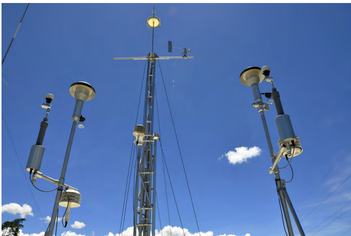
Sensores meteorológicos y toma de muestra de una estación de monitoreo automática.
