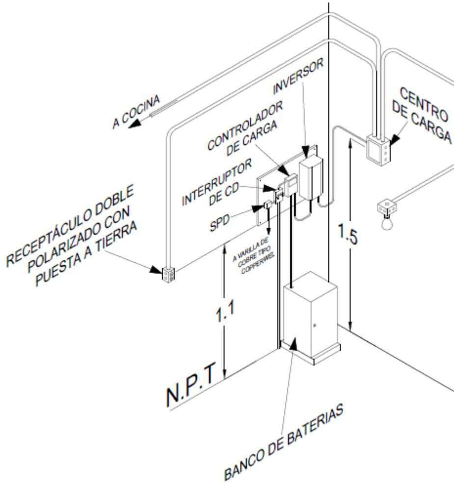
**Figura 1.1.6** Instalación eléctrica de equipos del panel solar en el interior de las viviendas
