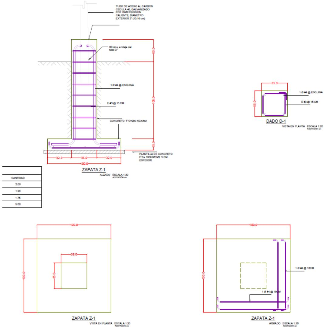
**Figura 1.1.3** Cimentación de tubo de acero galvanizado, pared gruesa, céd. 40, 76.2 mm (3"), 3 m de largo en concreto armado
