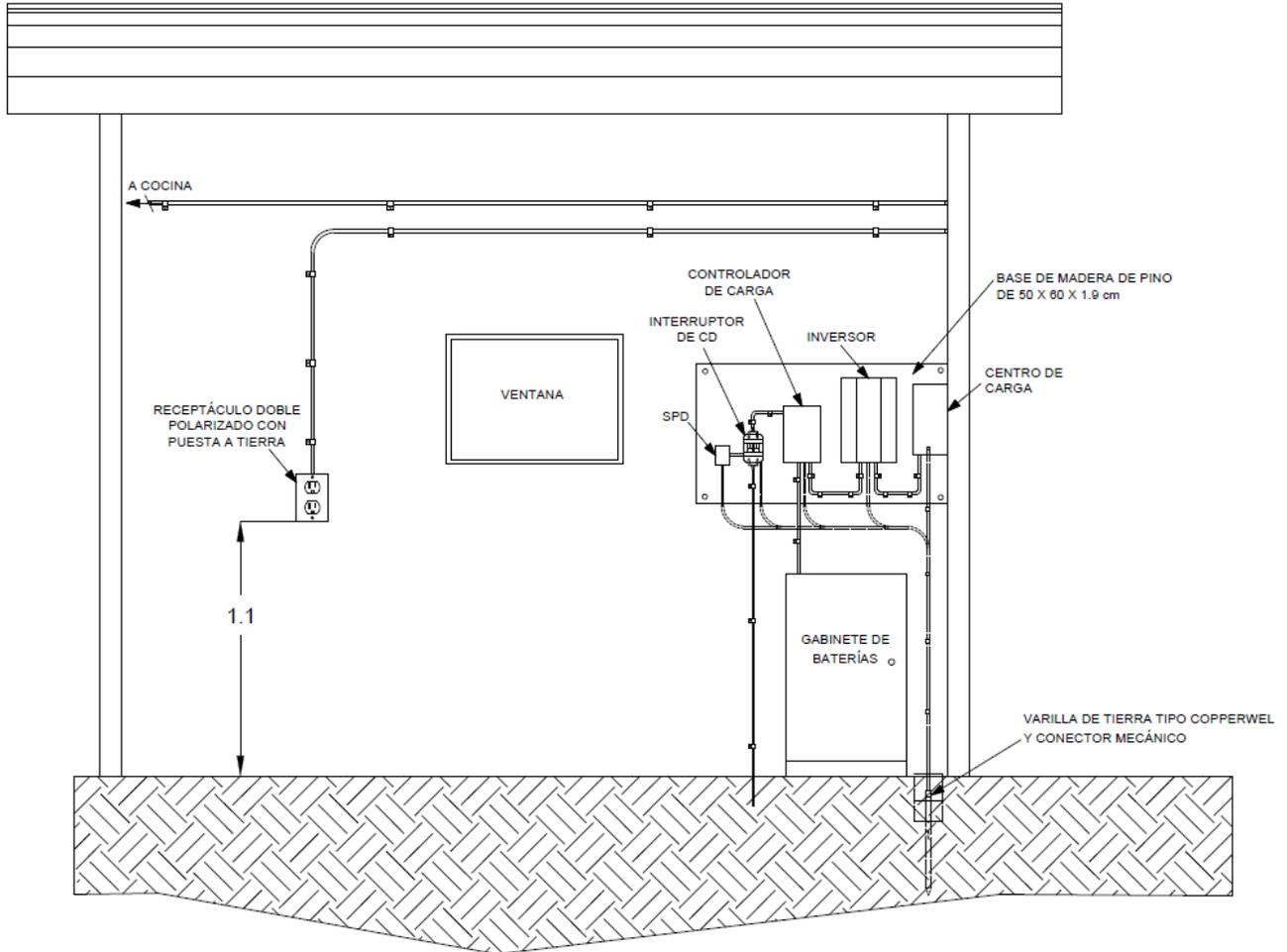
**Figura 1.1.4** Instalación eléctrica de equipos del panel solar en el interior de las viviendas
