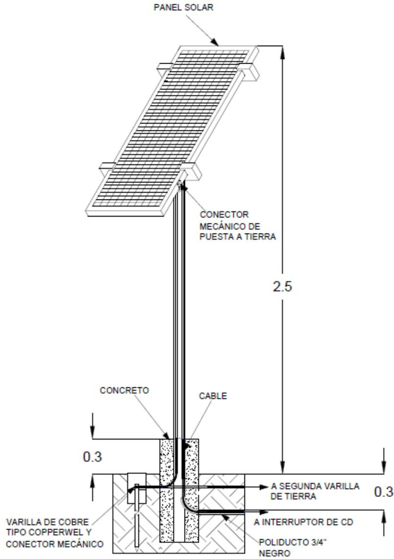
**Figura 1.1.2** Instalación de panel solar en tubo de acero galvanizado cédula 40
