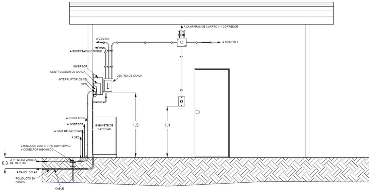
**Figura 1.1.5** Instalación eléctrica de equipos del panel solar en el interior de las viviendas
