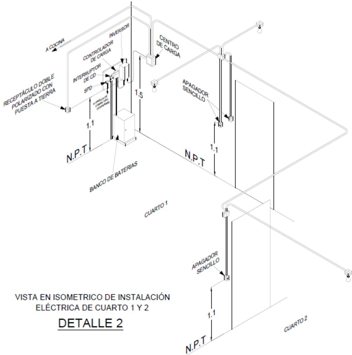
**Figura 1.1.8** Instalación eléctrica en las viviendas
