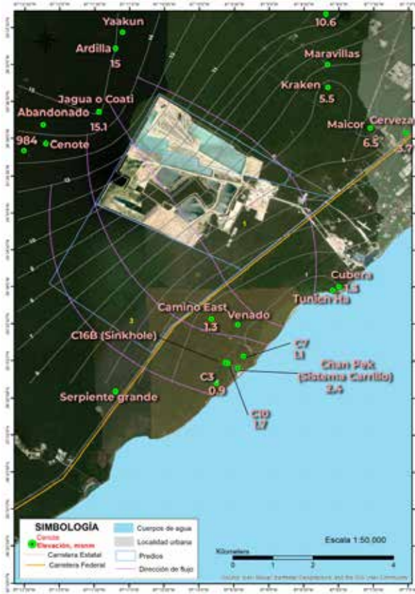
Figura 52. Dirección del flujo subterráneo.
