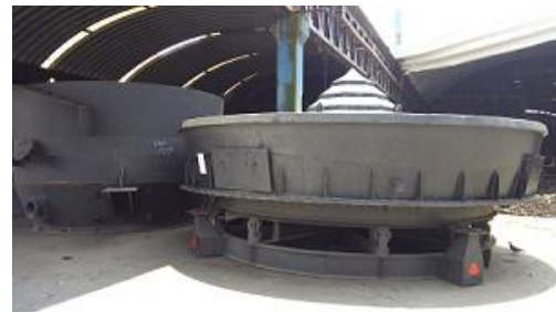
Fotografía 33. Filtros separadores, Bordo oriente, Etapa IV, diciembre de 2020. Proyecto Valorización de fracción orgánica de residuos sólidos urbanos (FORSU) mediante carbonización hidrotermal. UNAM.
