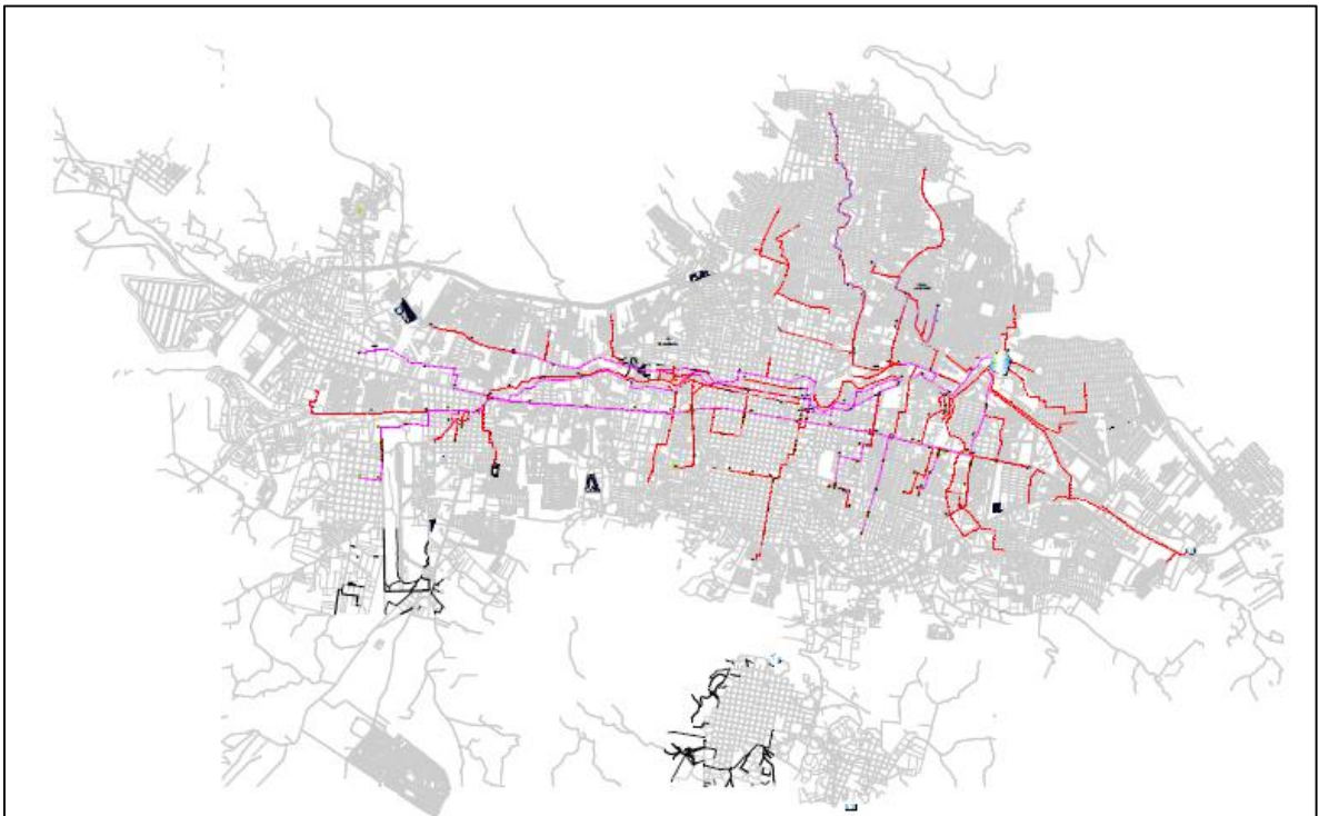
Figura 6.1. Esquema de la red primaria de alcantarillado de la ciudad de Tuxtla Gutiérrez (fuente SMAPA).
