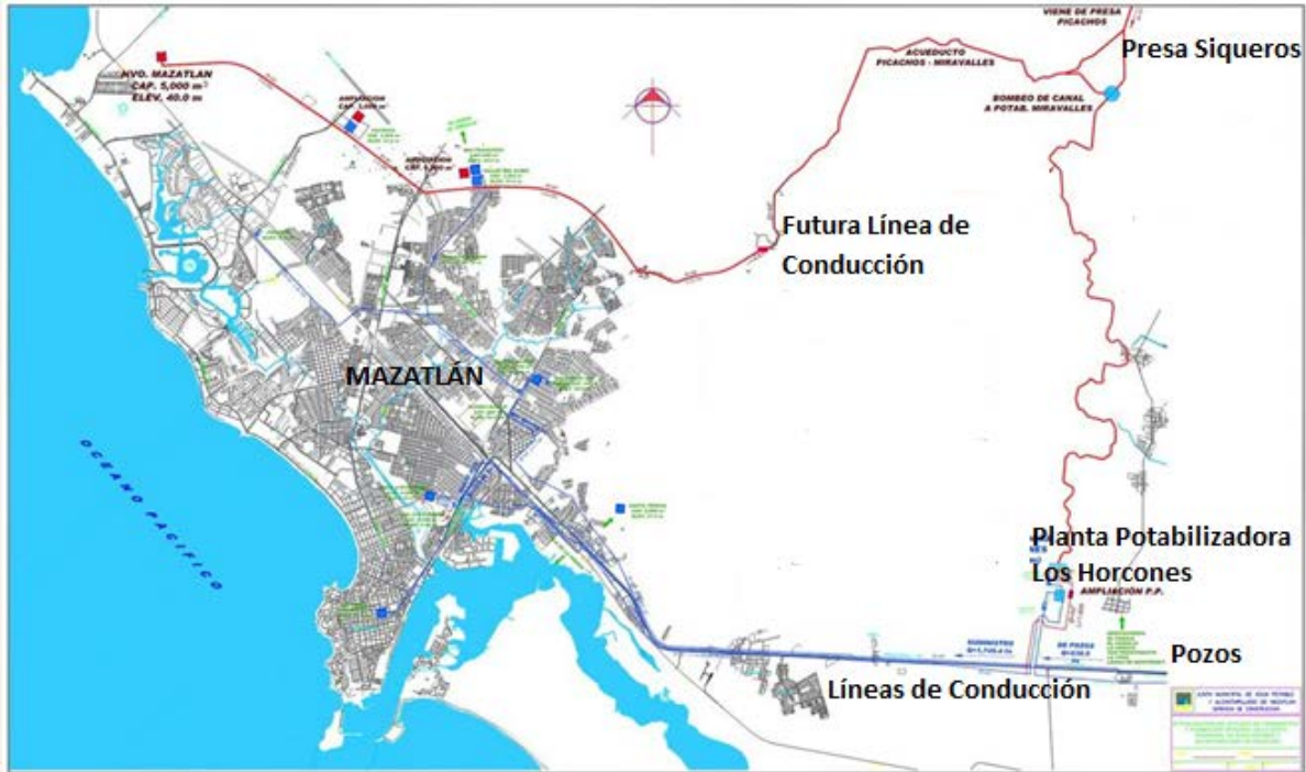
Figura 6.1. Sistema urbano de agua potable de Mazatlán
