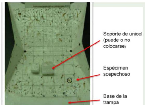
Figura 10.10 Partes de la trampa.
