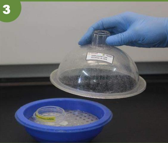
Depositar la caja Petri con solución A en un desecador con alcohol al 96% y colocarlo en la incubadora a 40°C.
