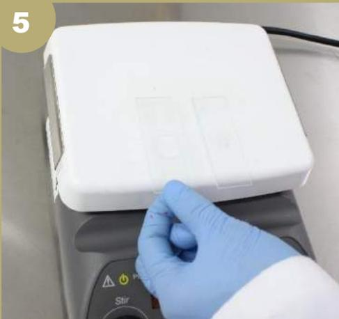
Colocar la preparación sobre una placa térmica a 90°C para fundir la parafina y obtener el sellado.
