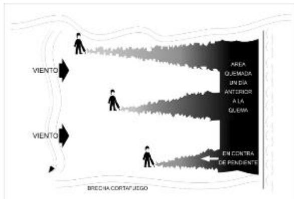
Esta técnica consiste en prender fuego en contra, y en posición paralela a la dirección del viento. Después de que el área a quemar se haya asegurado, mediante la apertura de brechas que la rodean y la línea base, se prenden líneas de fuego (1) (2) (3 y 4) en sentido opuesto a la dirección del viento a partir de la base superior.
