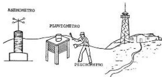
Los instrumentos meteorológicos necesarios para verificar las condiciones esperadas en la atmósfera, son: el anemómetro, el pluviómetro y el psicrómetro.
