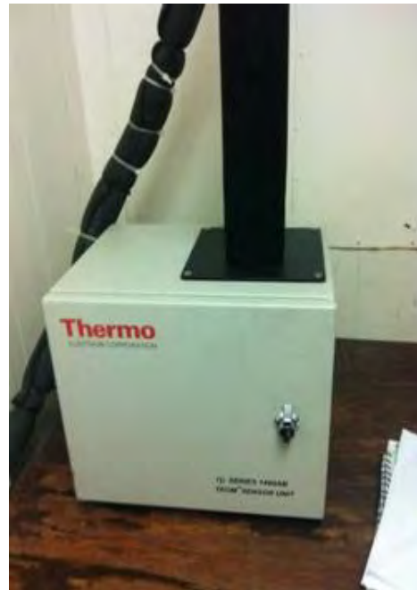
Figura 21. Unidad sensora para material particulado (PM 10 ).
