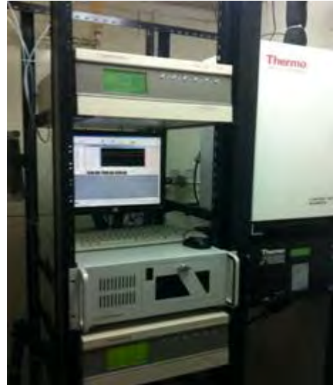
Figura 19. . Instrumentos de medición para medir la concentración de NO, NO 2 , NO x y SO 2 y para material particulado (PM 10 ).
