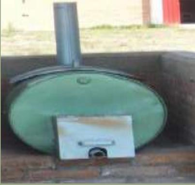
**Horno metálico para la producción de carbón**
