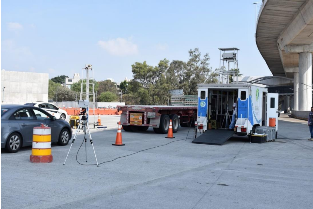
Figura 10. Identificación de automotores altos emisores, vía sensor remoto en los accesos de entrada a la Megalópolis
