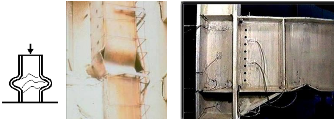
Figura 2.49 Pandeo de placas: a) esquemático; b) en columna; c) en trabe
