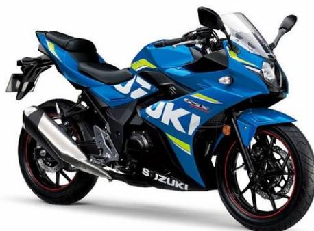
La empresa **SUZUKI MOTOR DE MÉXICO, S.A. DE C.V.**, notifica voluntariamente a esta Procuraduría Federal del Consumidor que ha identificado que en algunas motocicletas de la marca Suzuki Modelo GSX250R se puede presentar vibración excesiva en la bombilla del faro al entrar en resonancia con cierto régimen de RPMs del motor, si continúa utilizándose en estas condiciones, el filamento de la bombilla del faro puede romperse en poco tiempo y el faro se apagará.
