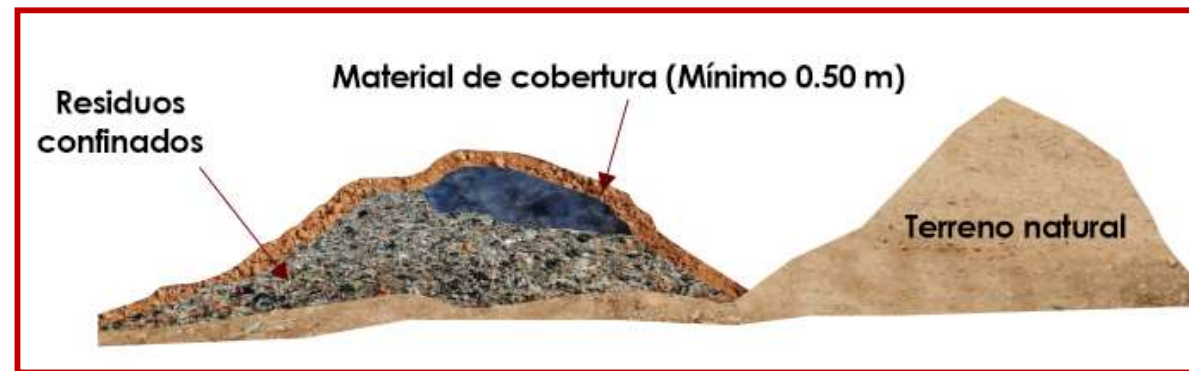
Supresión de ingreso de oxígeno al centro de la combustión. SICA. 2020
