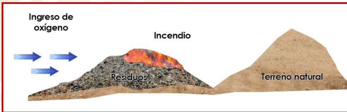
Supresión de ingreso de oxígeno al centro de la combustión. SICA. 2020
