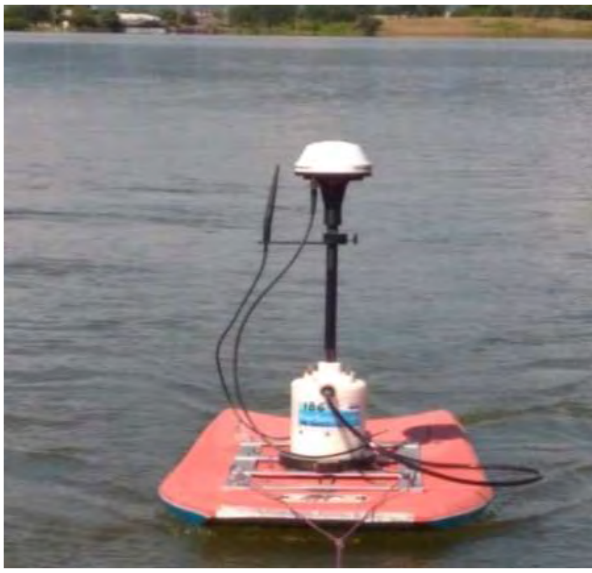
Medición barométrica y gasto con perfilador Doppler M9 en la presa Endhó
