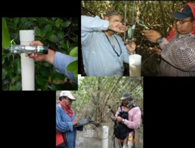
Sensor de nivel OTT Thalimedes en estiaje (arriba) y lluvias (abajo).
