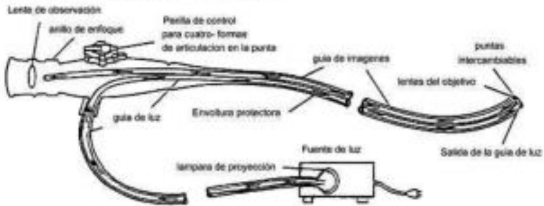
(b) Un boroscopio flexible con una fuente de luz
