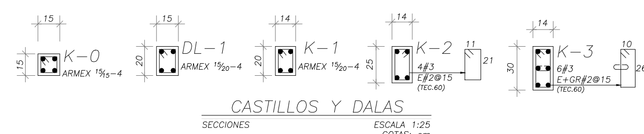
CIMENTACIÓN CASTILLOS, CONTRATRABES Y MUROS REFORZADOS ESCALA 1:75 COTAS: cm
