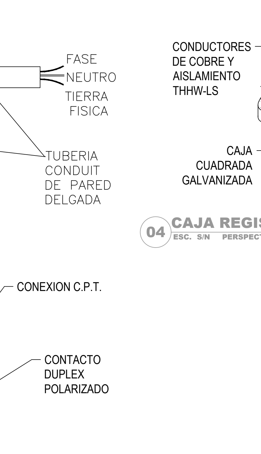
04 CAJA REGISTRO EN PISO ESC. S/N PERSPECTIVA
