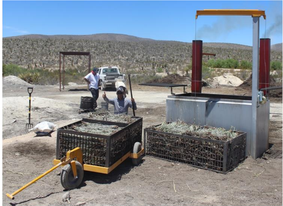
Equipo de extracción con canastillas y bases móviles
