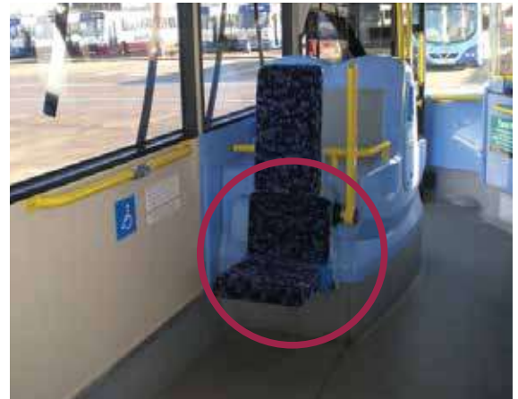
36. Respaldo para persona usuaria de silla de ruedas con asiento plegable Fuente: < https://bit.ly/2FVlxP7 >
