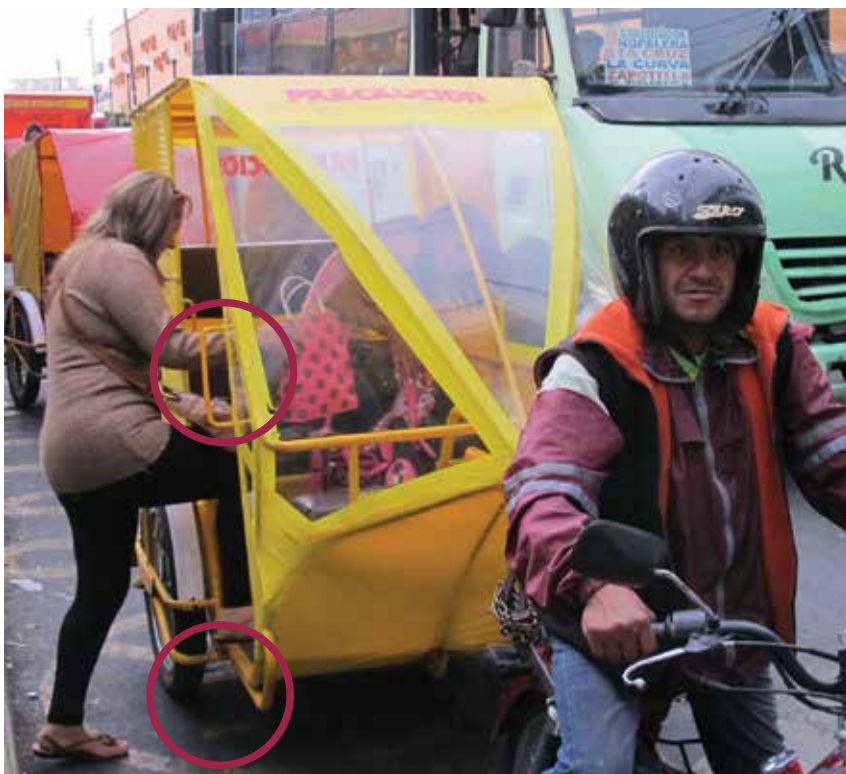
6. Brecha vertical permitida 20. Asidera de apoyo en el ascenso y descenso Fuente: Janett Jiménez
