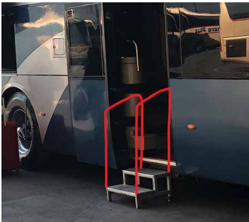
6. Dispositivo de transferencia exterior: 2 escalones máximo con pasamanos Fuente: Janett Jiménez
