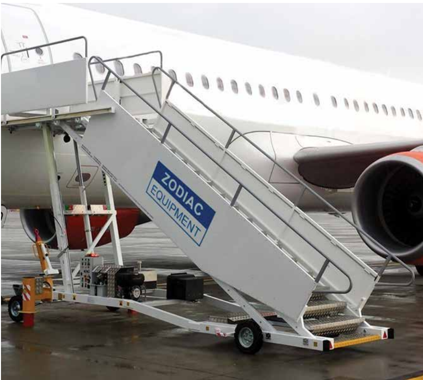
6. Dispositivo de transferencia: escaleras con pasamanos a ambos lados Fuente: < https://bit.ly/2Dxwv45 >
