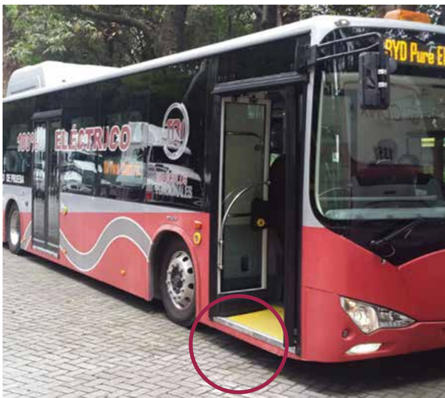
6. Brechas horizontal y vertical Fuente: Víctor H. Alvarado Ángeles
