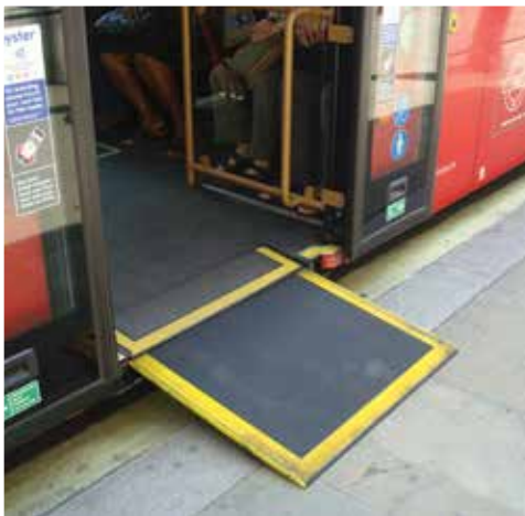
8. Dispositivo de transferencia: rampa en autobús de piso bajo Fuente: Janett Jiménez
