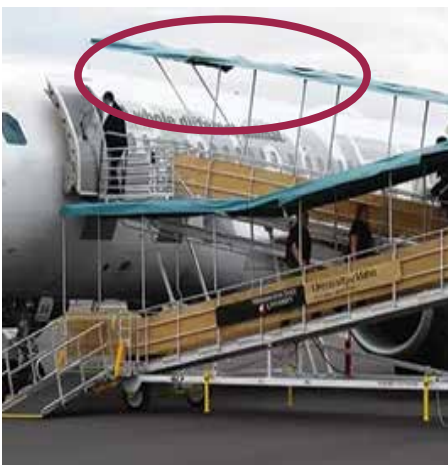
9. Cobertizo en dispositivo de transferencia exterior (rampa exterior) Fuente: < https://bit.ly/2S52KvI >
