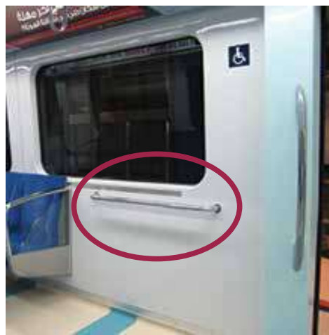
27 y 28. Barra horizontal fija 33. Señal visual en costado - altura Fuente: < https://bit.ly/2DTyv7w >
