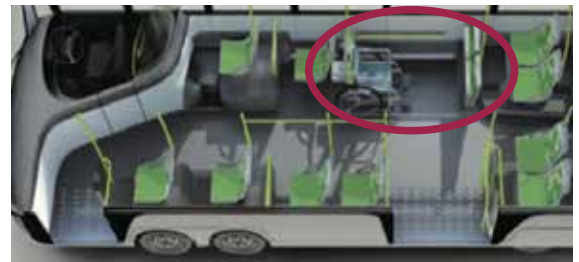
23. Persona mirando hacia atrás con respecto al desplazamiento del autobús 36. Asiento plegable Fuente: MLIT, 2007
