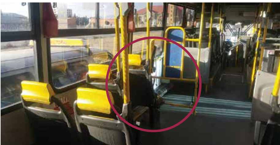
37 - 41. Asientos para personas con movilidad limitada cercanos al espacio para persona usuaria de silla de ruedas Fuente: Roberto Guardia Ramírez
