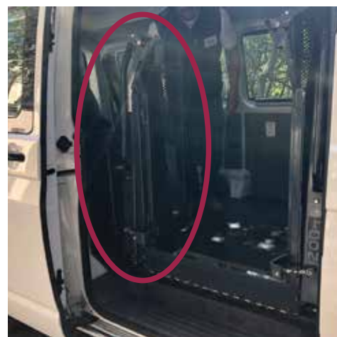
10. Plataforma elevadora de guarda vertical Fuente: Janett Jiménez
