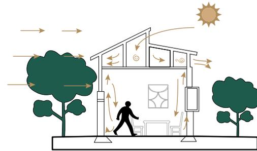
o abierta puede lograrse mediante un techo inclinado. Las aberturas en el techo inclinado o al nivel del cielo raso facilitan la salida de aire caliente.
