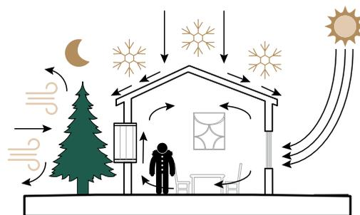
grados de inclinación se pierde de diez a 15% de ganancias de calor. Para garantizar la concentración del calor al interior de la vivienda se recomienda un techo bajo (Véase apartado Alturas mínimas de los espacios por zona climática).
