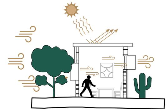
*Cubiertas.* Las cubiertas de materiales con una alta capacidad de reflejar y emitir la radiación solar son una buena opción para evitar la ganancia de calor. Un techo alto permite que el aire caliente se concentre en la parte superior, lo que favorecerá una temperatura agradable en el área habitable de la vivienda.
