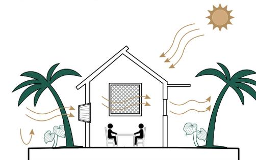
**Muros.** Para los muros que reciben radiación solar directa se debe considerar un sistema o material que retenga el calor y lo libere de manera lenta hacia el interior de la vivienda y facilite temperaturas agradables durante el día y la noche.
