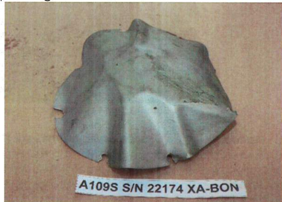
1.3.b. La cubierta presenta deformación hacia arriba
