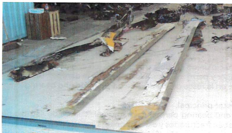
1.4.1.a. Daños en las cuatro palas del rotor principal
