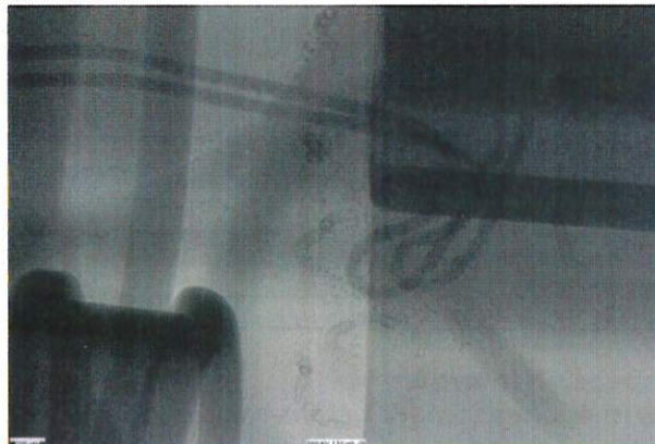
3.k. Bulbo B del MC, la cubierta de vidrio está intacta, así como el filamento elongado
